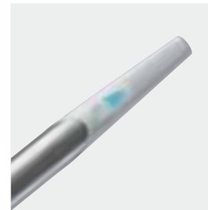
Камера C-U2 с технологией прогрессивного сканирования и электронным управлением легко встраивается в установку, обеспечивая оптимальную визуализацию объекта благодаря автоматической настройке параметров изображения в режиме реального времени: все, что нужно сделать стоматологу – это выбрать нужный объект.
