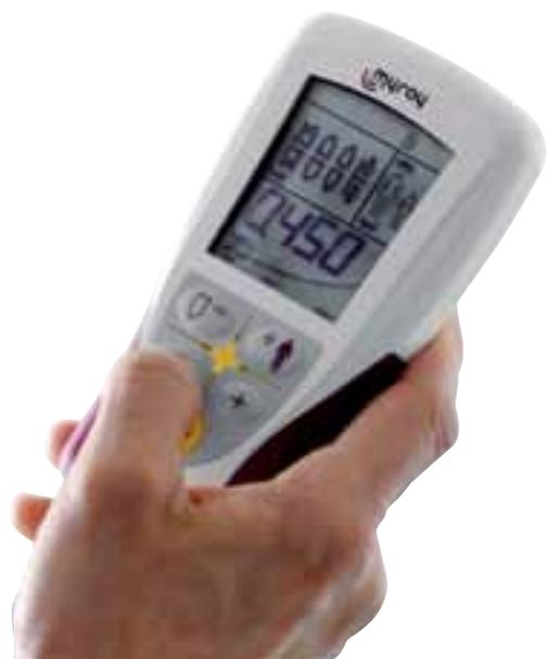
Цифровой блок управления обеспечивает полный спектр необходимых программ рентгенографии: все, что нужно сделать пользователю, - это выбрать интересующую область, а RXDC автоматически вычислит правильную экспозицию. Снимок отображается на мониторе, вмонтированном в стоматологическую установку.
