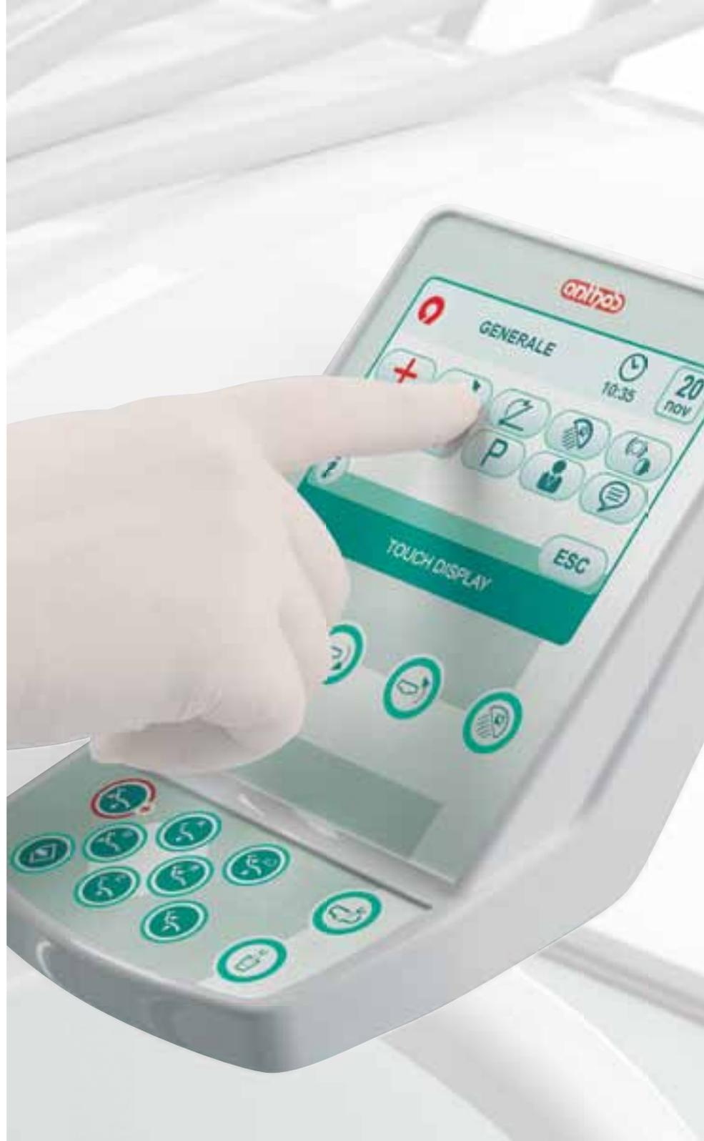
В стандартной комплектации модель Classe A7 Plus поставляется с комбинированной панелью управления, оснащенной сенсорным дисплеем Smart Touch и кнопочной панелью управления креслом. Посредством сенсорного дисплея осуществляется управление всеми инструментами и системой дезинфекции, встроенной в установку.
